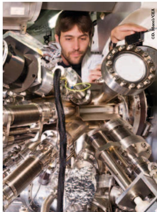
Instrument de l'ESRF permettant l'étude de la structure et de la morphologie de nanoparticules par diffusion de rayons X.
