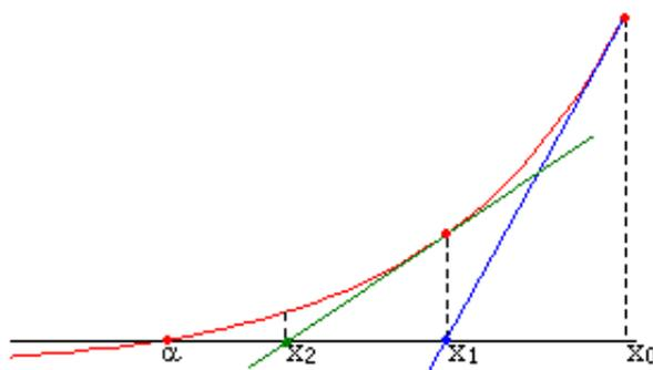
Nous avons déjà vu un exemple d'algorithme de Newton dans un cas très particulier : la méthode de Héron pour approcher  $\sqrt{2}$ . Dans ce cas la fonction considérée est  $f(x) = x^2 - 2$  on obtient
