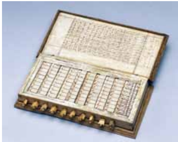
L'un des premiers modèles de l'abaque népérien, inventé par John Napier pour le calcul de produits et quotients.
