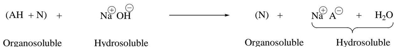
Cela se traduit par le passage de l'acide ( sous forme de sel) dans la phase aqueuse. Le produit neutre reste dissous dans la phase organique non miscible à l'eau. Par simple séparation de phase, on réalise la séparation chimique de AH et N .
