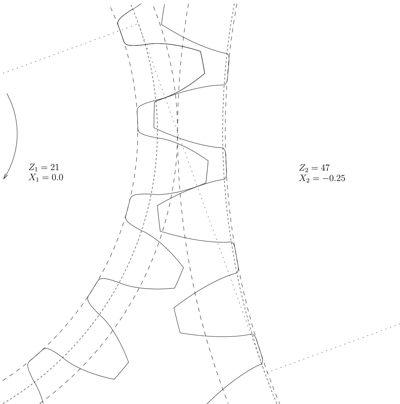
FIG. 1 – Représentation du contact au niveau d'un engrenage (module 4 mm)
