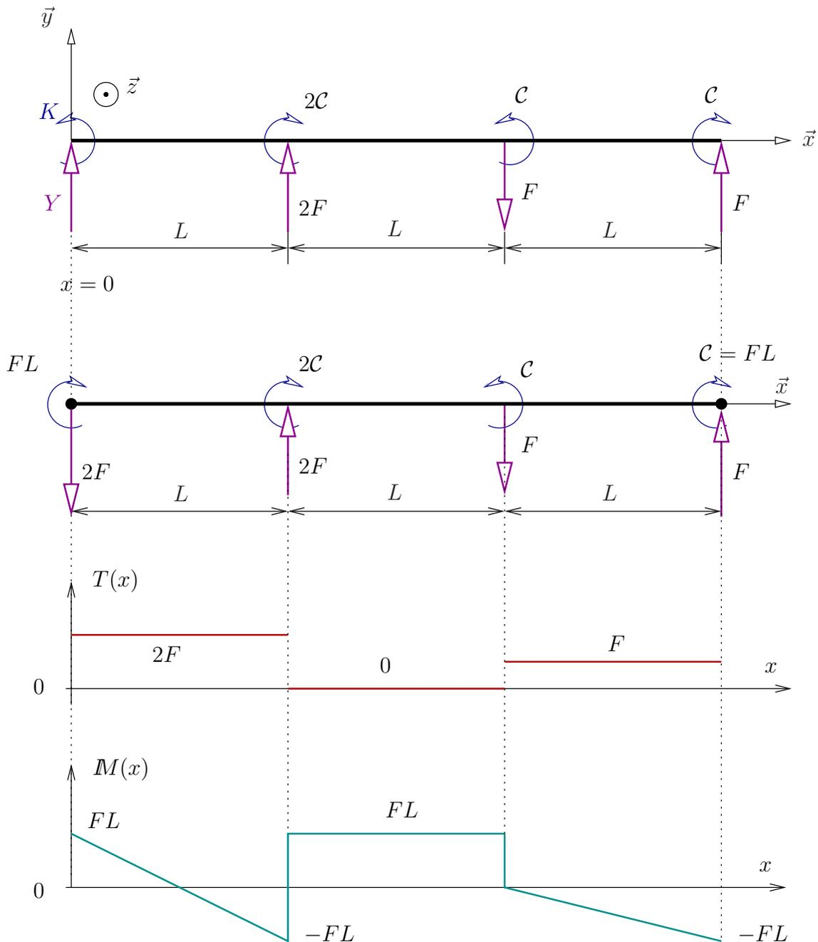
En réalisant trois coupures et en isolant une portion de poutre, il vient les diagrammes. .... [1+2]
