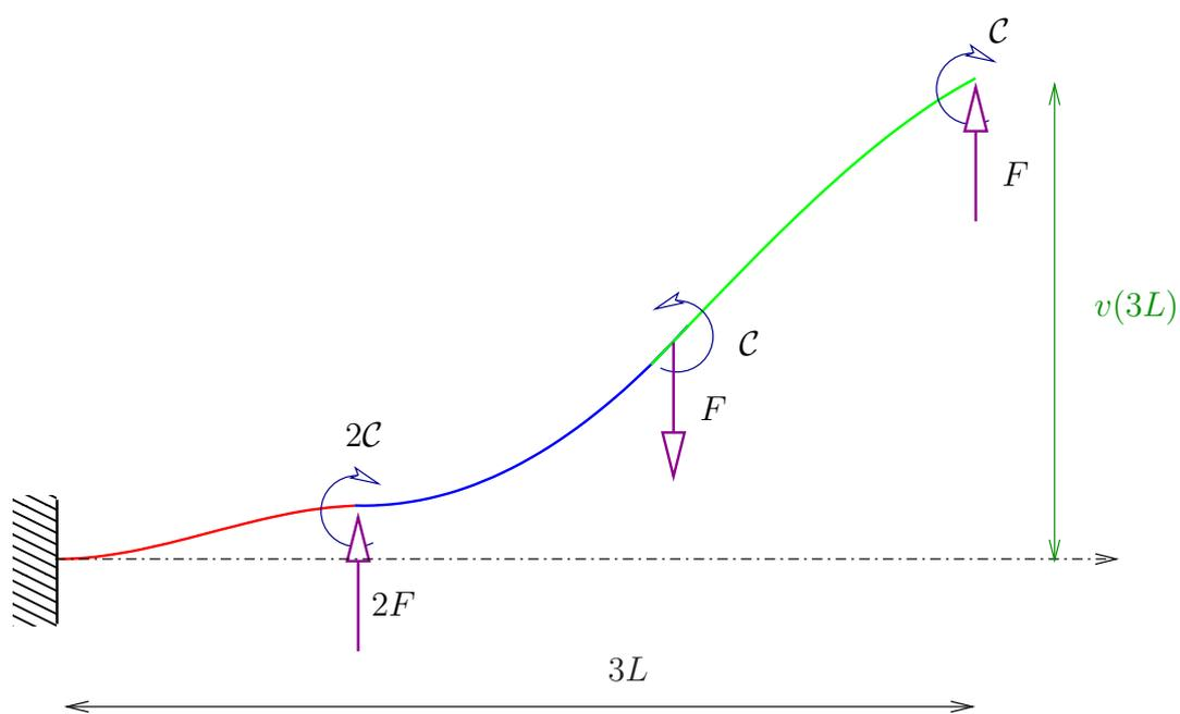
FIGURE 2 – Déformée de la poutre amplifiée.
