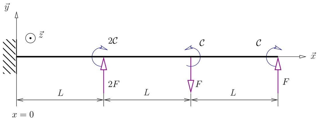
1) Déterminez analytiquement puis numériquement l'action exercée par l'encastrement sur la poutre. .... [2]
