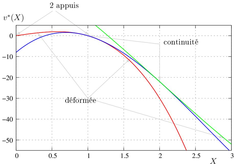
FIGURE 1 – Les 3 fonctions, représentant la déformée, présentent une continuité et une pente continue en  $X = 1$  et  $X = 2$ . Cette figure représente la déformée de la poutre amplifiée.
