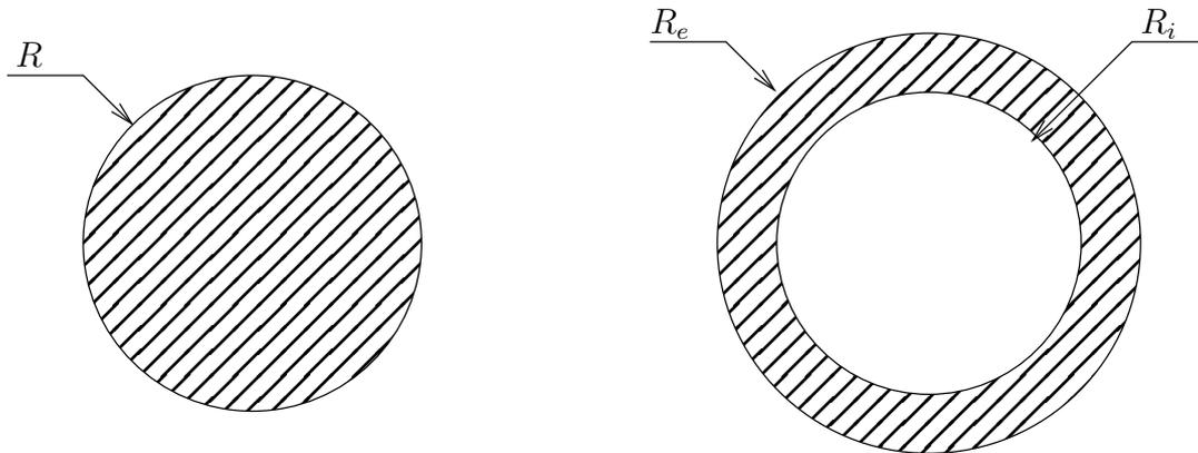
FIG. 2 – Deux sections droites de poutre soumises à un moment de torsion.
