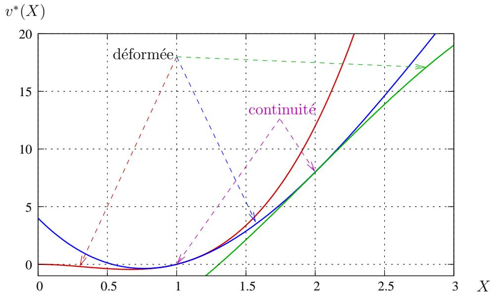
FIG. 1 – Les 3 fonctions, représentant la déformée, présentent une continuité et une pente continue en  $X = 1$  et  $X = 2$ . Cette figure représente la déformée de la poutre amplifiée de 15.6 environ.
