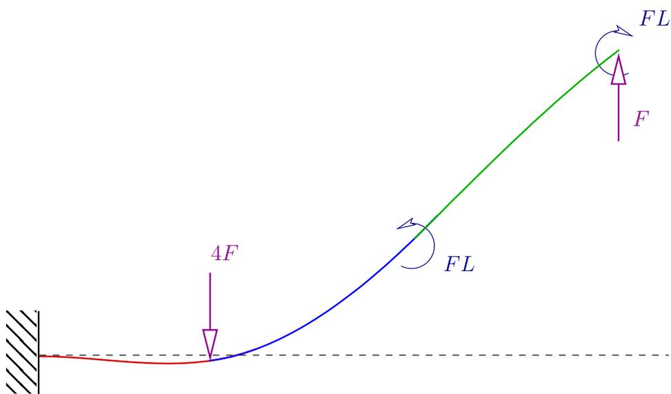
FIG. 2 – Déformée de la poutre amplifiée de 15.6 environ.
