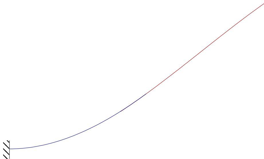
Le moment fléchissant est maximum en  $x = 0$  et vaut :  $M(0) = 5FL$ . La contrainte de tension est maximum en  $x = 0$  et  $y = \pm\frac{h}{2}$  et vaut :
