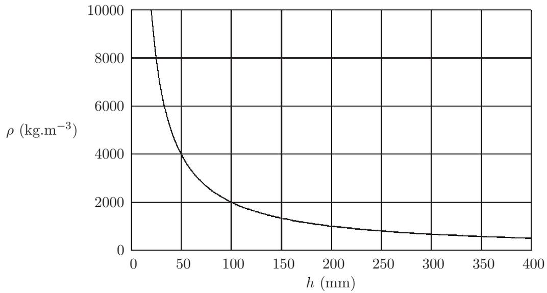
FIG. 1 – Evolution de la masse volumique du fluide  $\rho$  en fonction de la hauteur immergée  $h$ .
