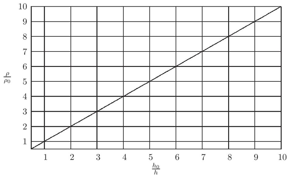
FIG. 2 – Evolution de la densité du fluide  $\frac{\rho}{\rho_0}$  en fonction du rapport de hauteur immergée  $\frac{h_0}{h}$  ( $\frac{h_0}{L} = 0.5$  et  $\frac{h_0}{2a} = 10$ ).
