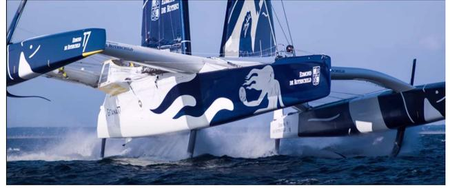
Lorsque sa vitesse (par rapport à l'eau) est supérieure à 15 kts (1 kt=1 nœud=1.852 km/h), 4 de ses 6 foils lui permettent de "voler" au dessus de la mer (les 2 autres foils sont alors hors de l'eau).
