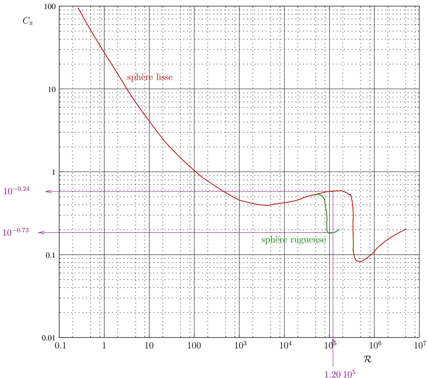
FIG. 1 – Evolution du coefficient de trainée  $C_x$  d'une sphère en fonction du nombre de Reynolds  $\mathcal{R}$ .
