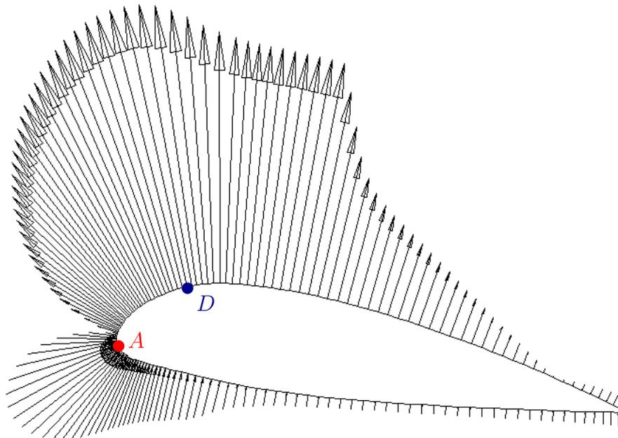
FIG. 3 – Représentation de la force répartie de pression du fluide sur le profil NACA 4220, pour le nombre de Reynolds  $\mathcal{R} = 10^5$  et pour l'incidence  $\alpha = 8.5^\circ$ . . . . . [1]
