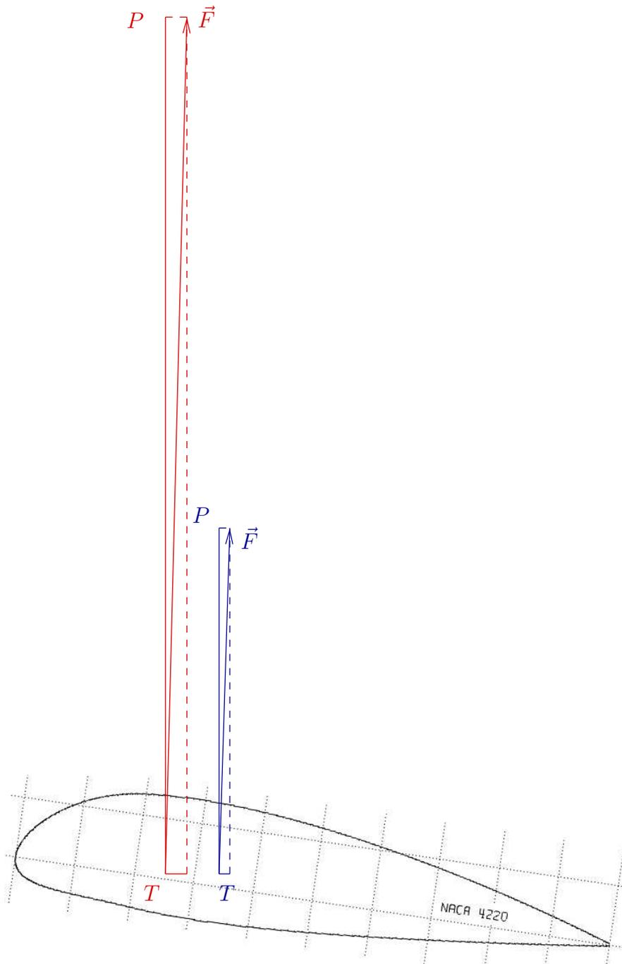
FIG. 1 – Vecteur force  $\vec{F}$  exercé sur le profil NACA 4220 en incidence de  $8.5^\circ$  :  $10 \text{ mm} \equiv 2 \text{ N.m}^{-1}$  [2.5]
