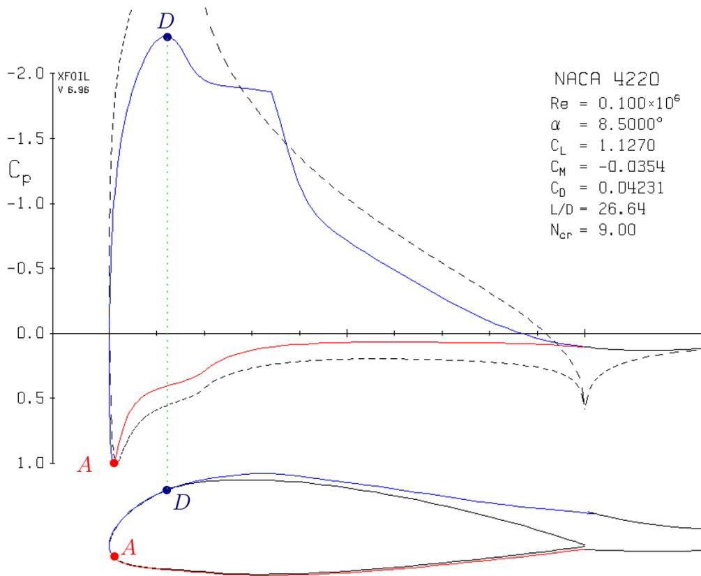
FIG. 2 – Evolution du coefficient de pression  $C_p$  pour le profil NACA 4220, pour le nombre de Reynolds  $\mathcal{R} = 10^5$  et pour l'incidence  $\alpha = 8.5^\circ$ . . . . . [1]
