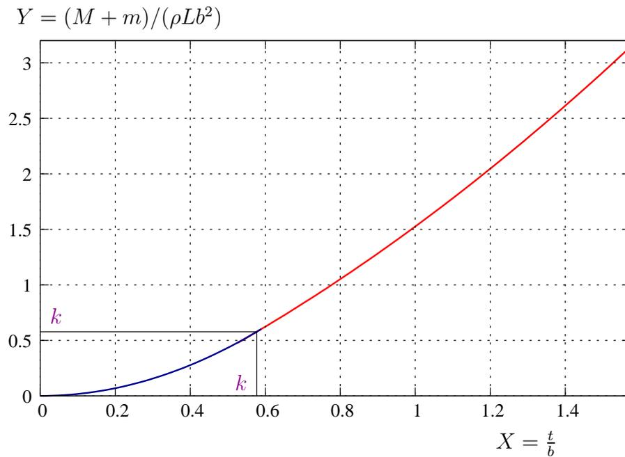
FIG. 3 – Evolution du rapport  $Y = (M + m)/(\rho L b^2)$  en fonction du tirant adimensionné  $X = \frac{t}{b}$ .
