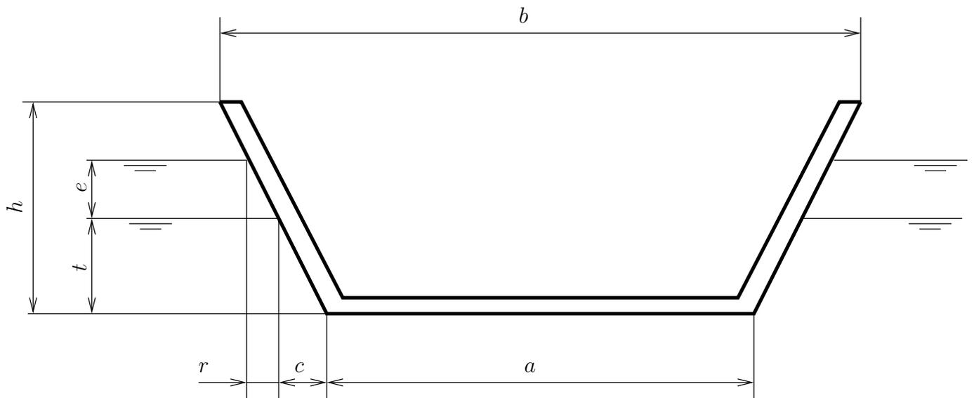
FIG. 2 – Section de l'embarcation flottante.
