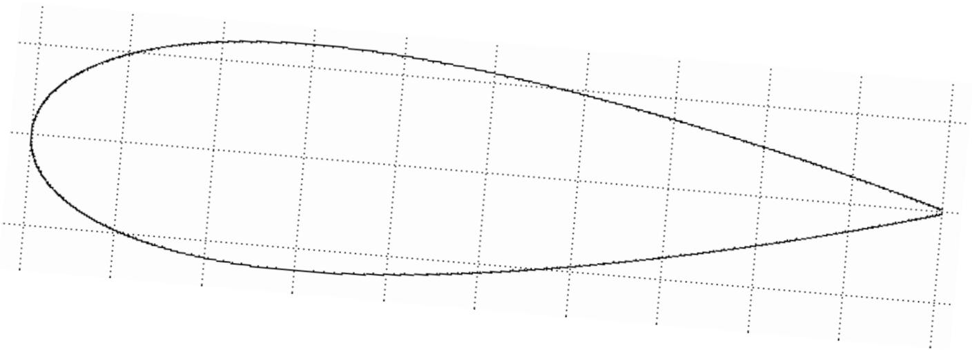
FIG. 3 – Profil NACA0025 incliné à  $5^\circ$  par rapport aux bords horizontaux de la feuille.
