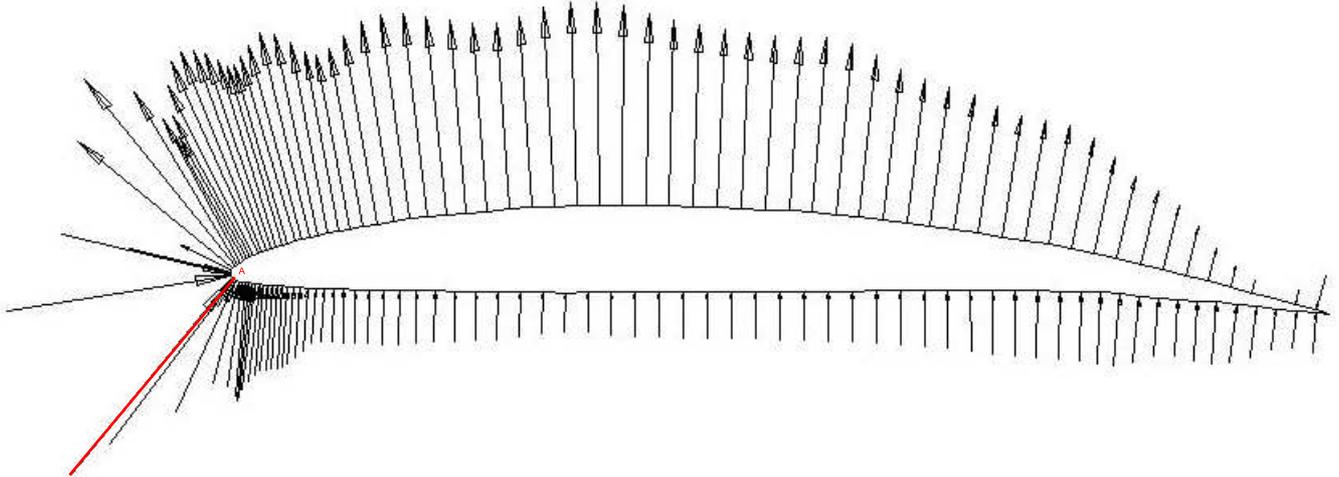
FIG. 2 – Evolution de la force répartie de pression sur le contour du profil pour le nombre de Reynolds  $\mathcal{R} = 1.2 \cdot 10^6$  et pour une incidence de  $2^\circ$ . Le fluide arrive horizontalement.
