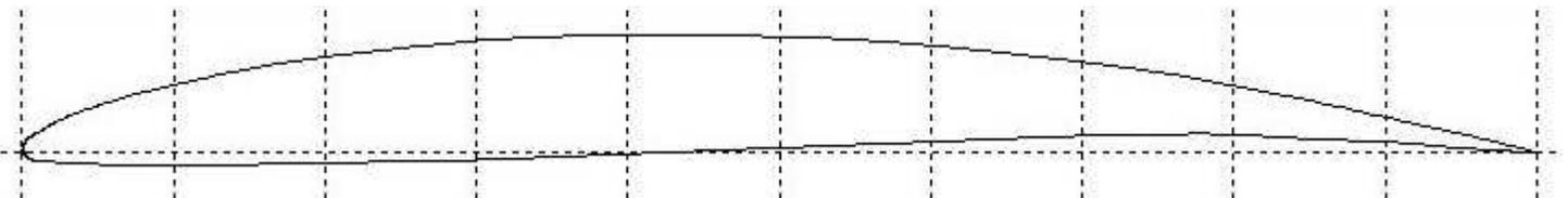
FIG. 3 – Profil NACA 63A608 dessiné en incidence nulle.
