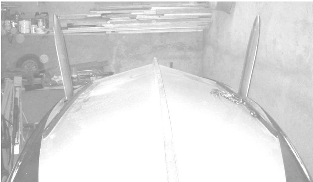
FIG. 2 – Visualisation des 2 dérives sorties sur un bateau retourné, en construction.
