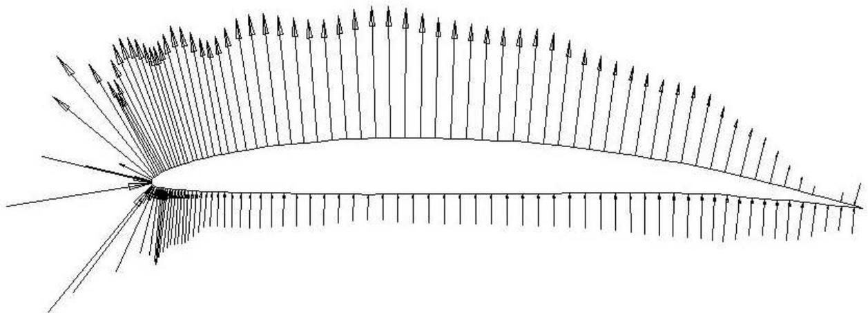
FIG. 6 – Evolution de la force répartie de pression sur le contour du profil pour le nombre de Reynolds  $\mathcal{R} = 1.2 \cdot 10^6$  et pour une incidence de  $2^\circ$ . Le fluide arrive horizontalement de la gauche.
