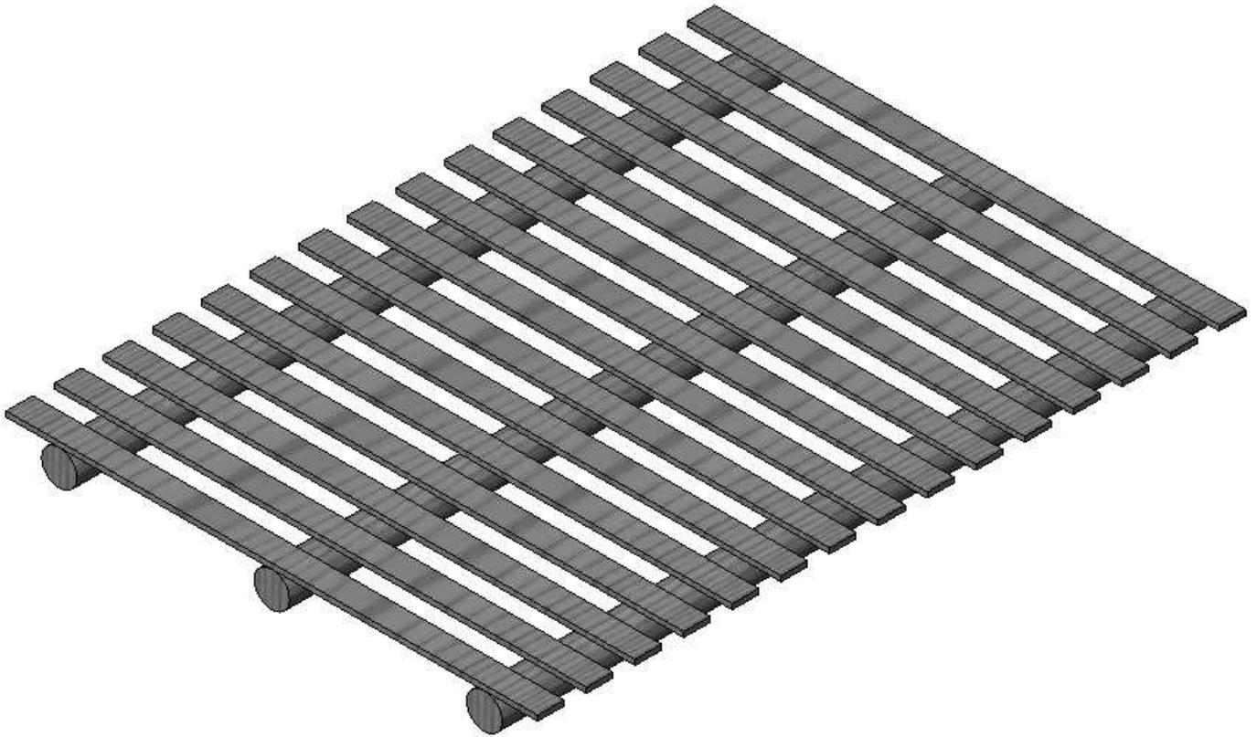
Un radeau est construit à l'aide de 3 rondins de 20 cm diamètre et 4 m de long sur lesquels sont fixés 15 planches de 3 cm d'épaisseur, 15 cm de large et 3 m de long le tout en pin de masse volumique  $\rho' = 340 \text{ kg.m}^{-3}$ .
