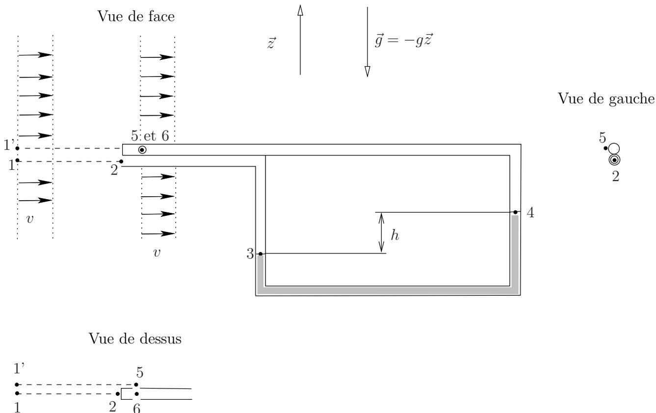
FIG. 1 – Dispositif de mesure de la vitesse d'un écoulement par tube de pression statique et tube de Pitot.
