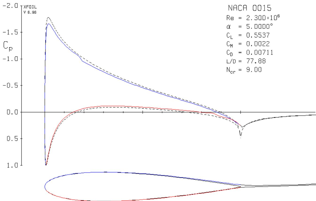
FIG. 2 – Evolution du coefficient de pression  $C_p$  pour le profil NACA 0015 pour le nombre de Reynolds  $\mathcal{R} = 2.3 \cdot 10^6$  et pour une incidence de  $5^\circ$  où  $C_z = 0.5537$  et  $C_x = 0.00711$ .
