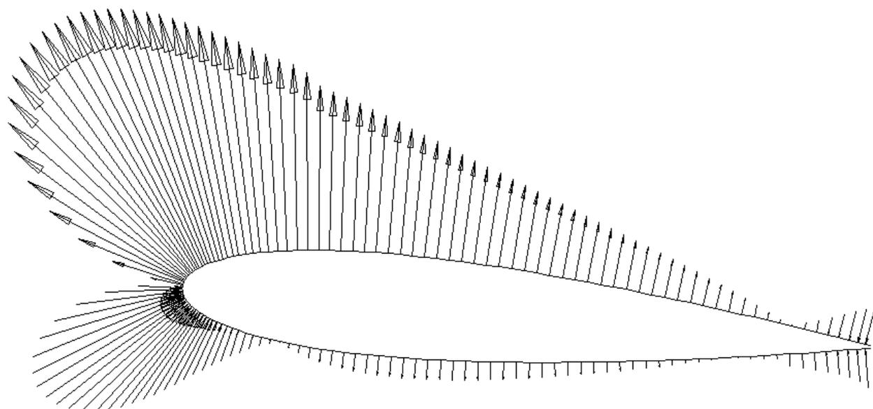
FIG. 3 – Représentation de la répartition de force de pression exercée en tous les points du contour du profil NACA 0015 pour le nombre de Reynolds  $\mathcal{R} = 2.3 \cdot 10^6$  et pour un angle d'incidence de  $5^\circ$ . Le profil est incliné de  $5^\circ$  par rapport aux bords horizontaux de la feuille.
