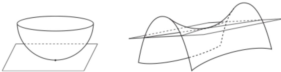
FIGURE 8 – Position par rapport au tangent dans les cas elliptique et hyperbolique [Aud06].
