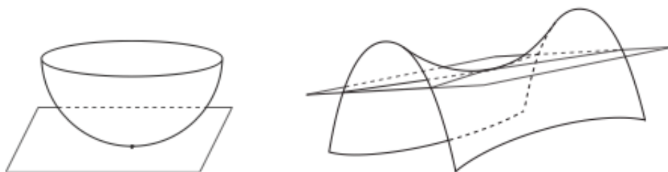
FIGURE 1 – Position par rapport au tangent dans les cas elliptique et hyperbolique [Aud06].
