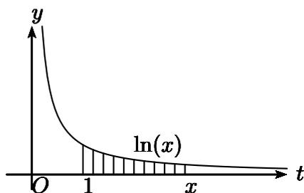
FIGURE 19 – Le graphe de  $t \mapsto \frac{1}{t}$  et le logarithme
