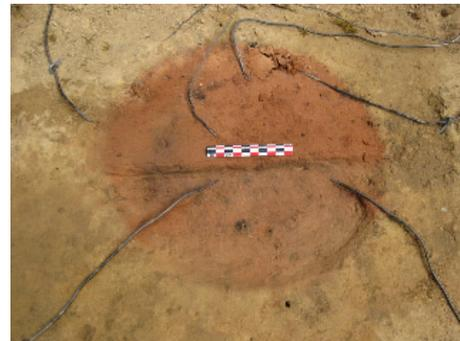
FIG. 5.11 – Fouille du sol pour déterminer la position de l'interface et les positions des thermocouples.
