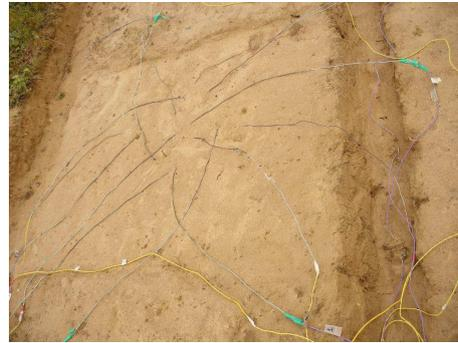
FIG. 5.3 – Les thermocouples sont mis dans le sol à différentes positions.
