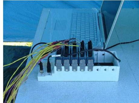
FIG. 5.9 – Les thermocouples sont liés à l'ordinateur.
