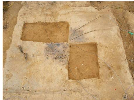
FIG. 5.7 – Fouille à l'intérieur du sol. Détermination de la position de l'interface et des positions des différents thermocouples.
