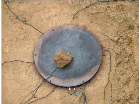
FIG. 5.8 – Plaque électrique utilisée pour chauffer le sol.
