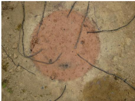
FIG. 5.10 – Altérations à la surface du sol produites par la plaque.
