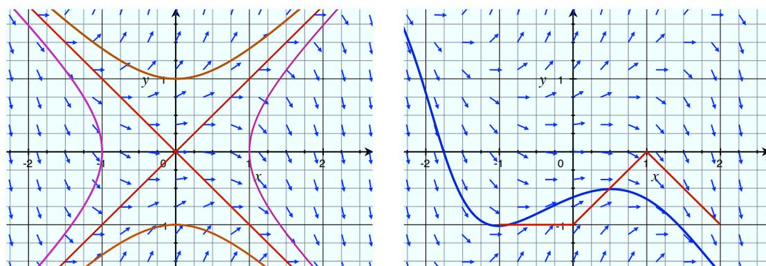
FIGURE 1 – Gauche : des isoclines. Droite : Une solution exacte et la méthode d'Euler
