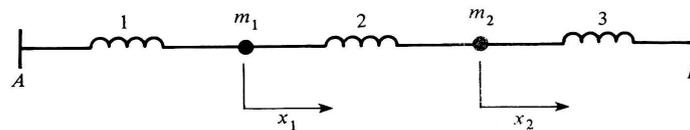
On note  $x_1, x_2$  la position des masses  $x_1, x_2$  de sorte que lorsque  $x_1 = x_2 = 0$ , les 3 ressorts sont détendus. A l'instant initial, les deux masses sont à leur position initiales  $x_1(0) = x_2(0) = 0$ , et que les deux vitesses initiales sont  $x_1'(0) = 2, x_2'(0) = 0$  (la 2ème masse est à l'arrêt). On suppose que les seules forces s'exerçant sur les masses sont celles exercées par les ressorts.
